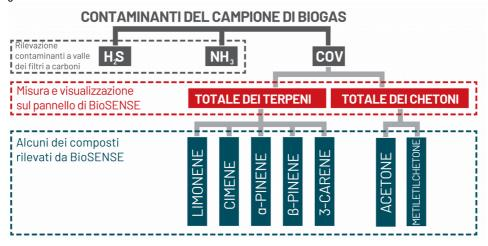
Il sistema di monitoraggio previsto è progettato specificamente per rilevare e misurare contaminanti nel biogas e cioè:
